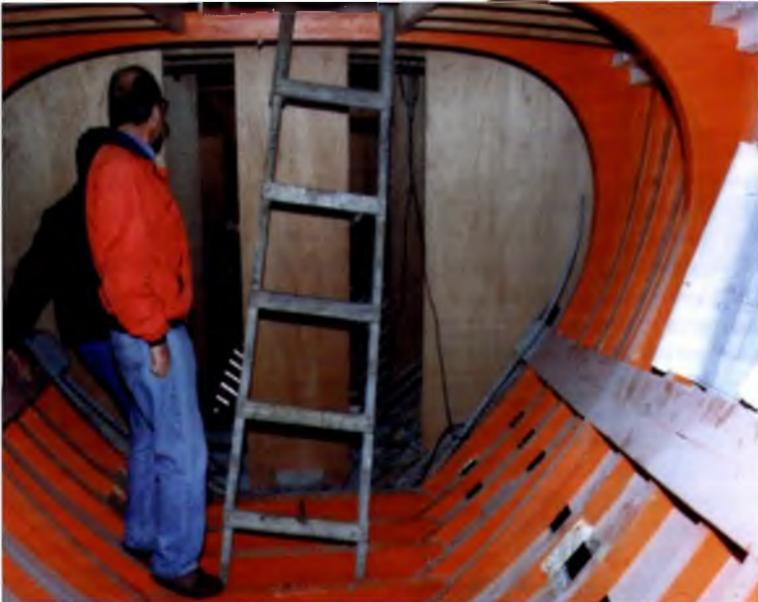
Las bulárcamas de viraró, conforman una nueva estructura del "Esperanza". Fueron trazadas para aportar un mayor refuerzo al casco y permitir que las landas de los obenques tuvieran una mejor descarga de sus esfuerzos, en lugar de hacerlo directamente al casco, conforme el proyecto original.
